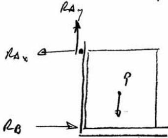
Aislado la plataforma, se pueden aplicar las ecuaciones de Newton-Euler
