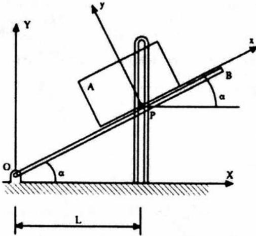
En el sistema de la figura la placa A tiene masa  $M$  y dimensiones despreciables y puede deslizar sobre la barra giratoria  $OB$ . En el punto medio  $P$  del lado de contacto hay un pivote que desliza dentro de una ranura vertical. La barra  $OB$  tiene también masa  $M$  y longitud  $2L$  y gira con velocidad angular  $\omega$  constante en sentido antihorario, accionada por un motor en la articulación  $O$ . El conjunto está situado en un plano vertical.
