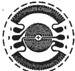
Fig. 8.13. Divers types de rosettes (Doc. Vishay-Micromesures).
