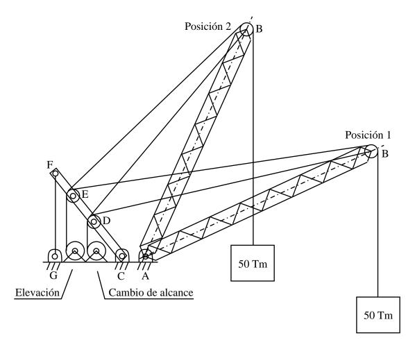
En la figura se han representado dos posiciones de trabajo: la posición 1, en la que la pluma forma un ángulo de 30° con la horizontal; y la posición 2, en la que dicho ángulo es de 60°. Para pasar de una a otra se hace girar el tambor de cambio de alcance, permaneciendo fijo el de elevación: si el tambor de cambio de alcance enrolla cable, se pasa de la posición 1 a la 2; si desenrolla cable, se pasa de la 2 a la 1. El paso de la posición 1 a la 2 y regreso se considera un ciclo de trabajo.
