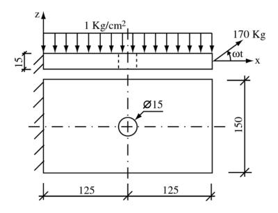
Determinar el coeficiente de seguridad de que se dispone respecto al fallo por fatiga de la placa, e indicar cuál es la sección más peligrosa.
