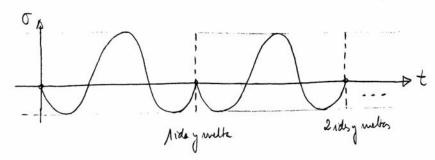
Entrues, en 50.000 sids y meltes tendriannos 50.000 melos con Tum=-89 y Tuix = 178, y otros 50.000 con Tuix = 0 y Tuix = -89. Se podría aplicar la firmula de Palugrem-Hinr. In embargo, dedo que los ciclos de 0 a -89 m de compresión y con un bajo minel de tentión, se vom a desporcier, teniendose en cuenta tolo los ciclo, de -89 a 178. Pera demostrer que los ciclos de compresión tienen escesa nifluencia, apliquemos el cuitaro de fooduran pera ellos.
