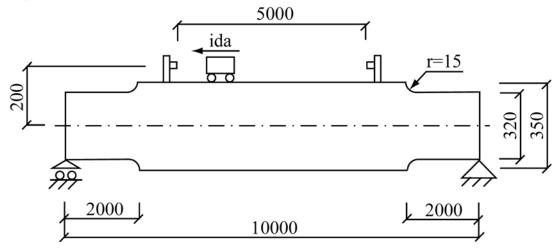
Sabiendo que, a lo largo de la vida útil del puente-grúa, se van a producir 100.000 recorridos completos de ida y vuelta, y que el carro vuelve descargado, determinar el espesor de chapa que debe poseer la viga. Indicar también los dos puntos más críticos de la viga.
