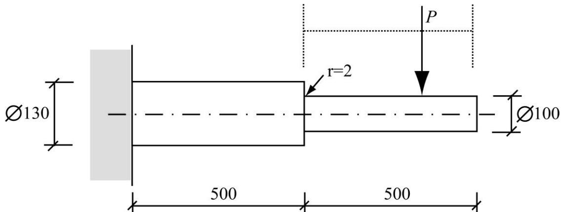
Una carga  $P$  actúa sobre la viga en el tramo de menor radio (parte derecha en la figura), moviéndose ininterrumpidamente de un extremo a otro del tramo, aunque con la lentitud suficiente para que se puedan despreciar los efectos dinámicos del movimiento de la carga sobre la viga.
