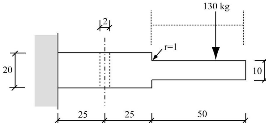
Una carga de 130 kg actúa sobre la viga en el tramo de menor canto (parte derecha en la figura), moviéndose ininterrumpidamente de un extremo a otro del tramo, aunque con la lentitud suficiente para que se puedan despreciar los efectos dinámicos del movimiento de la carga sobre la viga.
