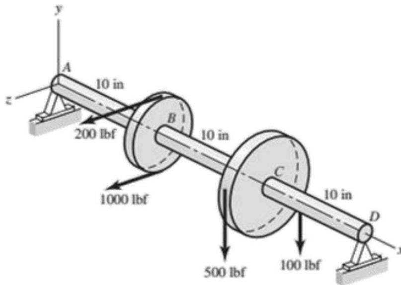
Determinar el diámetro que ha de tener el eje para soportar 100.000 vueltas.
