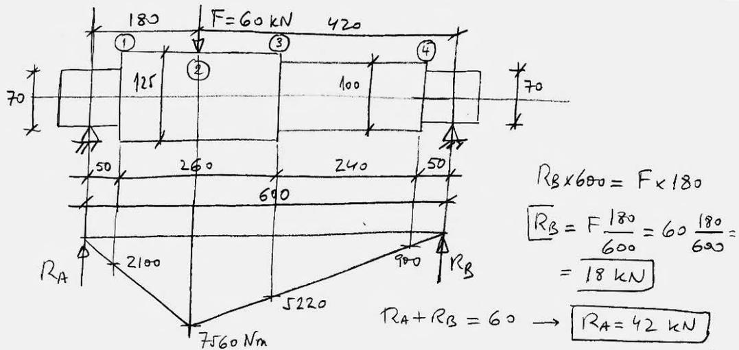
a) Las tensiones máximas en las secciones ①-④ son los siguientes:
