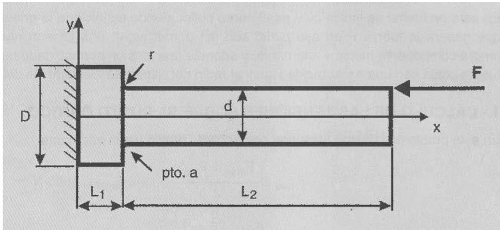
Si la carga  $F$  varía continuamente entre  $-1000$  N y  $+4000$  N, se desea calcular el coeficiente de seguridad respecto al fallo a fatiga a vida infinita del punto inferior de la sección de la entalla (punto "a" en la figura).
