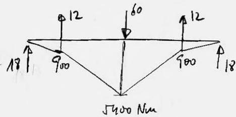
La sección central (crítica) soporta un momento flector  $M = 5400 \div 8600 \text{ Nm}$
