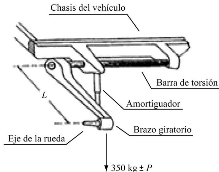
La segunda figura muestra el detalle de la barra de torsión.
