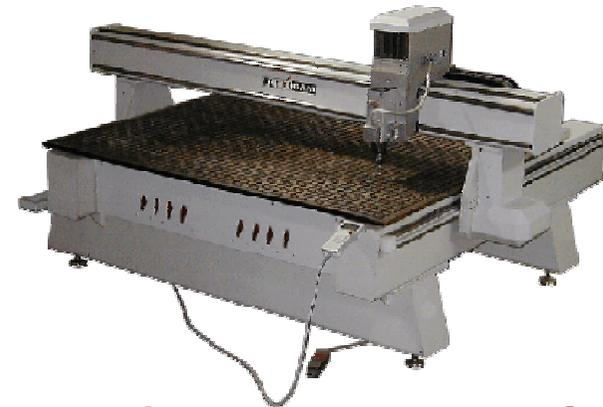
Fresadora puente o pórtico
