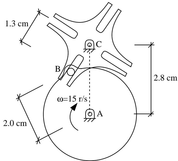
Sobre el eje A del disco actúa un par motor T que lo hace girar con una velocidad angular constante de 15 r/s, mientras que en el eje C de la rueda de Ginebra actúa un par resistente de 50 Nm que se opone al movimiento.
