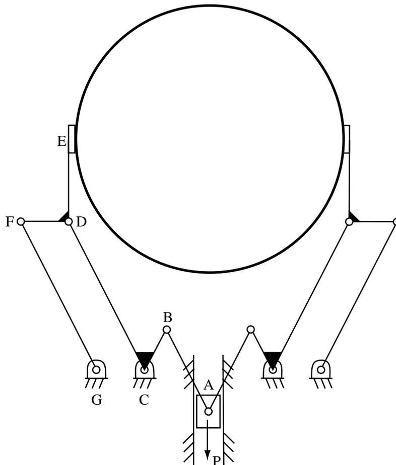
Si P es el valor de la fuerza que actúa sobre el pistón A, determinar, en la posición de la figura, la fuerza normal de agarre de las pinzas sobre el objeto en función de P. No se considera rozamiento entre las pinzas y el objeto, ni tampoco acción gravitatoria sobre el sistema.
