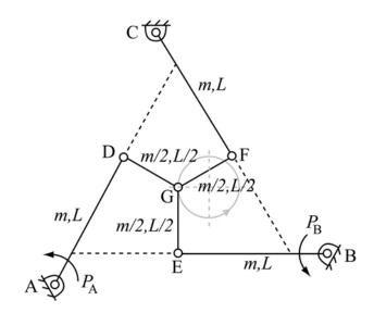
En la posición de la figura, las barras AD, BE y CF, de longitud L y masa m, se hallan sobre los lados de un triángulo equilátero, mientras que las barras DG, EG y FG, de longitud L/2 y masa m/2, se encuentran perpendiculares, respectivamente, a las anteriores. En las articulaciones A y B se han montado sendos motores rotativos que proporcionan los pares necesarios para lograr el movimiento deseado del manipulador.
