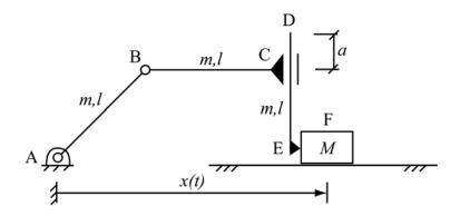
Los tres brazos del robot tienen masa m y longitud l. Durante el movimiento del robot, el tercer brazo, DE, se halla siempre vertical, y su extremo E contacta en todo momento sobre el mismo punto del bloque. En la posición representada, la distancia entre la corredera del par prismático C y el extremo superior del tercer brazo D, toma valor a. Además, el primer brazo, AB, forma 45° con la horizontal, y el segundo, BC, se halla horizontal.
