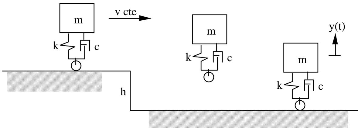
a) El movimiento del móvil se trata de un simple Arco parabólico.
