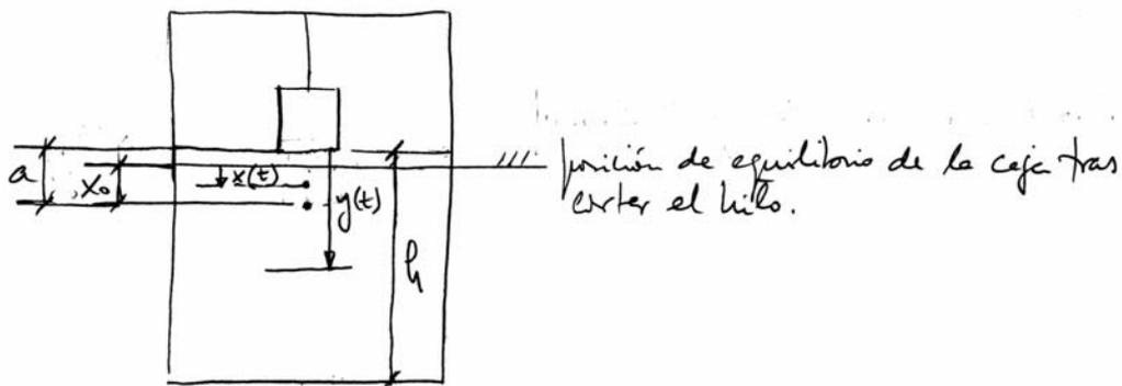
la caída del bloque se produce según un movimiento uniformemente acelerado bajo la acción de la gravedad,
