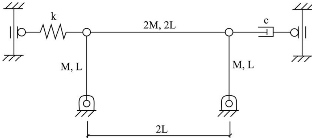
Si los parámetros del sistema toman los valores  $M=5$  kg,  $L=30$  cm,  $c=25$  Ns/m,  $k=800$  N/m,  $g=9.81$  m/s<sup>2</sup>:
