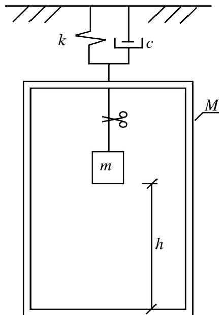
Si los valores de los parámetros son  $M=100$  Kg,  $m=20$  Kg,  $k=400$  N/m,  $c=10$  Ns/m,  $h=2$  m, y el valor de la gravedad se considera  $g=9.81$  m/s<sup>2</sup>, determinar:
