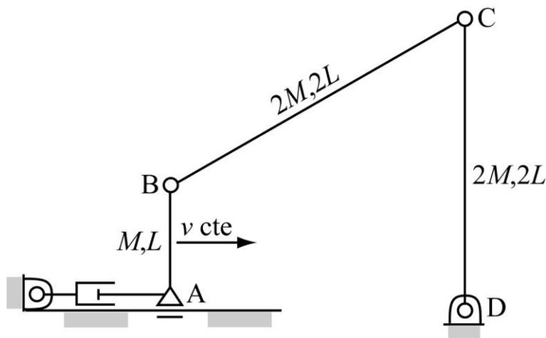
Si, en el instante representado, en el que las barras AB y CD se hallan verticales, la velocidad de la barra AB es  $v$ , horizontal y hacia la derecha, de valor constante, determinar:
