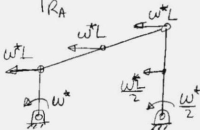
Para evitar que  $F$  y  $R_A$  den potencia virtual, en el mecanismo de 3 gdl resultante se impone una velocidad nula del punto A (como si fuese una articulación), y
