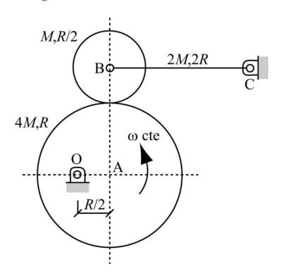
Si la excéntrica gira en sentido antihorario con velocidad angular  $\omega$  constante, propulsada por un motor rotativo situado en la articulación O, determinar, en la posición del sistema representada en la figura:
