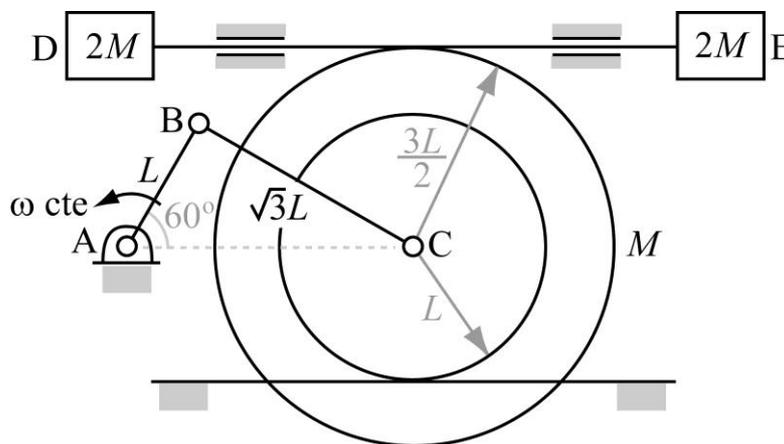
Si, en la posición del mecanismo que se muestra en la figura, en la que las barras AB y BC se hallan perpendiculares, la barra AB gira con velocidad angular  $\omega$  saliente, de valor constante, determinar:
