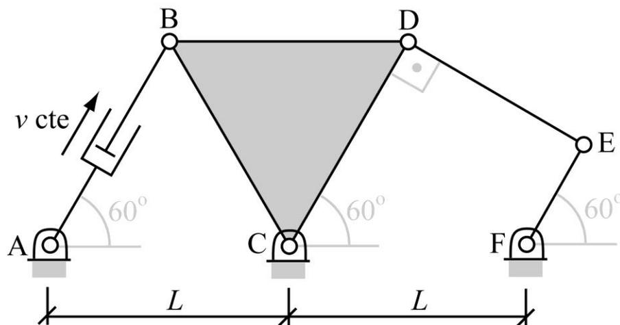
Para la posición del mecanismo representada en la figura, en la que la velocidad de alargamiento del pistón es  $v$  de valor constante, determinar:
