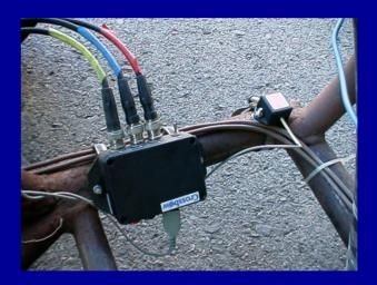
Tensiones: medios puentes de Wheatstone para medida de esfuerzos flectores.
