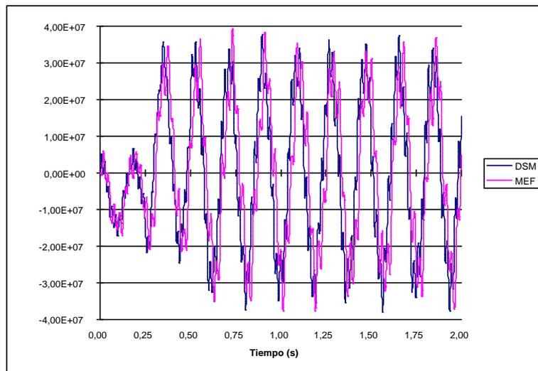
**Fig. 4.** Historia de la tensión normal máxima en la sección media de la barra con DSM y MEF.
