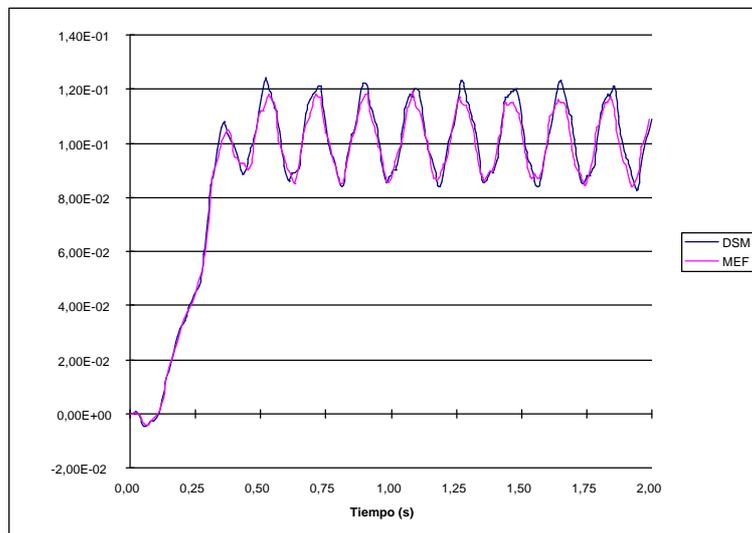
**Fig. 3.** Historia de la coordenada y del extremo de la barra con DSM y MEF.
