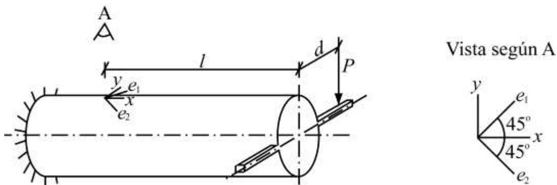
a) Dibujar el diagrama de momentos flectores y torsores que provoca la carga sobre el cilindro, indicando sus valores máximos.
