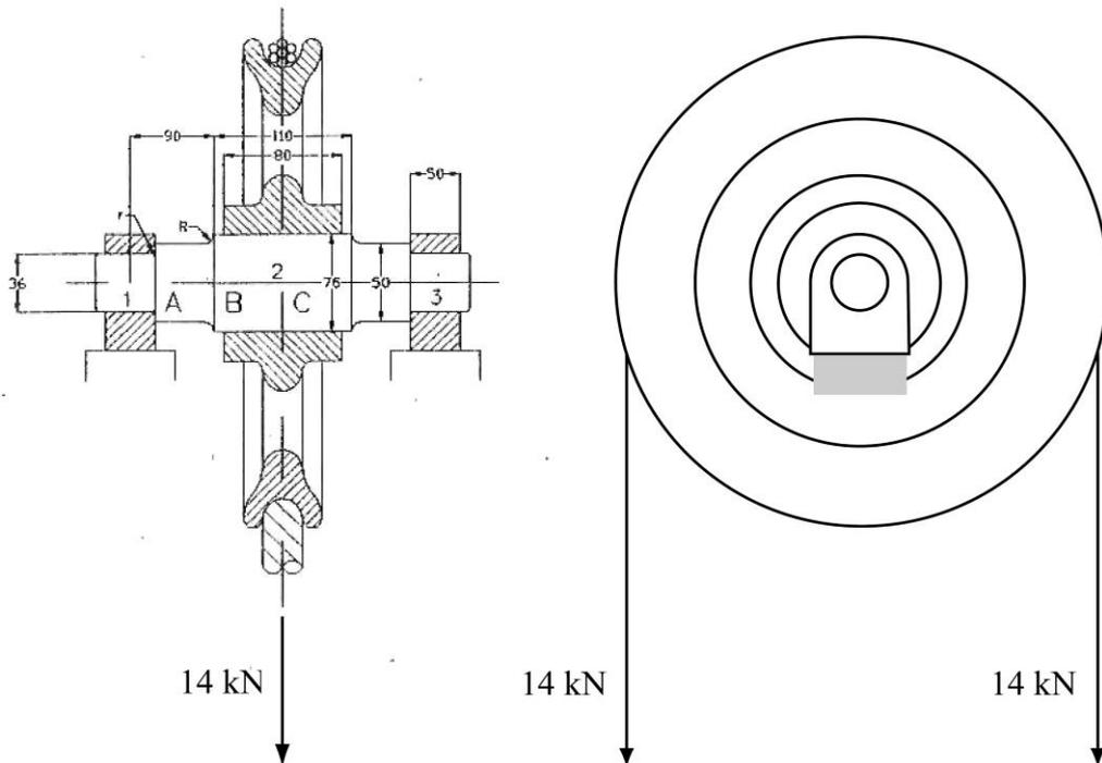
Sabiendo que  $R=10$  mm y  $r=3$  mm, que el eje está fabricado con acero de límite de rotura  $S_u=910$  MPa y límite de fluencia  $S_y=603$  MPa, y que el acero ha sido mecanizado, calcular el coeficiente de seguridad de que se dispone en los tres supuestos siguientes:
