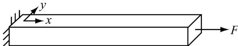
Si se colocaran dos bandas extensométricas 1 y 2 según los ejes  $x$  e  $y$ , respectivamente, en medio puente de Wheatstone, para medir la fuerza  $F$ , ¿qué posiciones ocuparían dichas bandas en el puente de Wheatstone y por qué?
