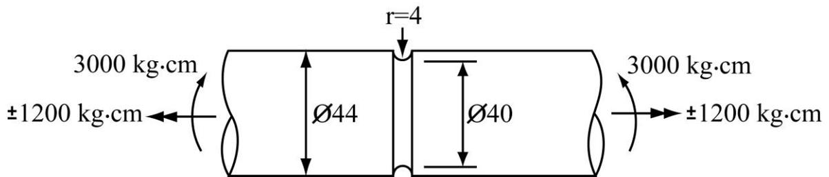
Si el eje soporta un momento flector constante de 3000 kg.cm, y un momento torsor alternado de 1200 kg.cm que varía con la misma frecuencia con que se produce el giro del eje, determinar los coeficientes de seguridad disponibles frente a fallo por fatiga a vida infinita y frente a fluencia.
