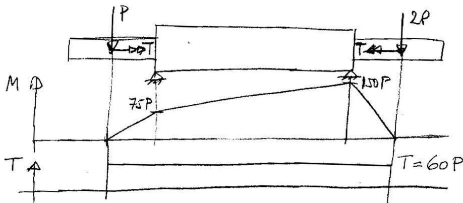
La sección crítica será la menor en el apoyo derecho. La sección está sometida a flexión rotativa con momento flector  $M = 150P$ , y a torsión continua con momento torsor  $T = 60P$ .
