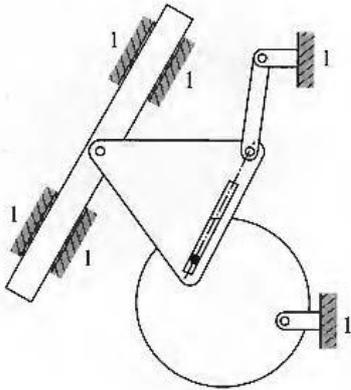
2- En la leva de disco con seguidor de pie plano de la figura, dibujar las las velocidades de los puntos en contacto de leva y seguidor. A continuación, dibujar cada elemento por separado, indicando las fuerzas normales y tangenciales que soporta debido al contacto leva-seguidor.
