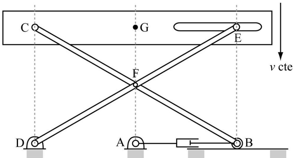
Si, en la posición de la figura, la barra  $DE$  forma un ángulo de  $30^\circ$  con la horizontal, y la plataforma desciende con velocidad  $v$  constante, determinar, para el instante representado:
